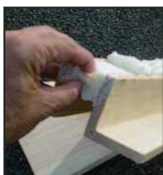
Réticulé la mousse devient semi-rigide.
